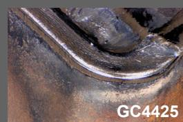
Результат: пластина конкурента изношена из-за пластической деформации. GC4425 работала на 50 % дольше при стабильном и прогнозируемом износе.
