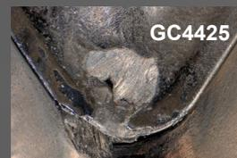
Результат: пластина конкурента имеет следы сильного лункообразования, в то время как GC4425 смогла изготовить на 80 % больше деталей при стабильном и прогнозируемом износе по задней поверхности.
